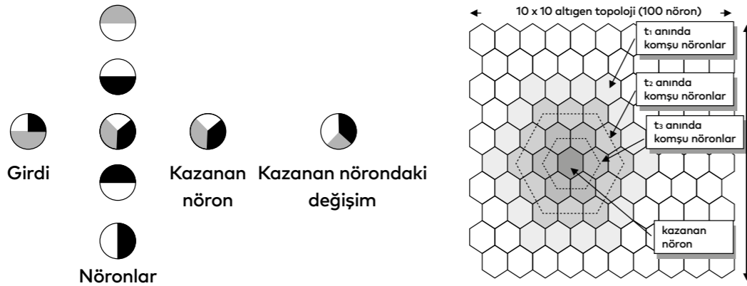
Şekil 24: Kazanan Vektörün Girdi Vektörüne Göre Değişimi ve Eğitim Boyunca Azalan Doğruluk Yarıçapı
