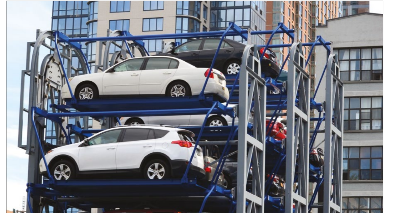
Şekil 45: Dönel Tip Otopark Uygulaması
